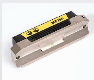
Base prismática rectificada con precisión. Dos orificios para soportes y adaptaciones personales.
