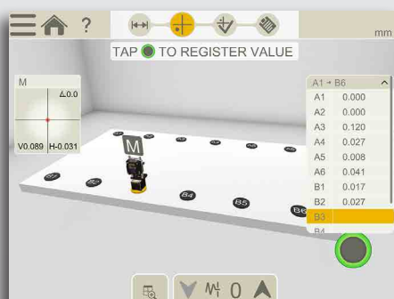
Programa de medición de planitud básica. Perfecto para asientos de máquina, alojamientos del compresor, etc.
